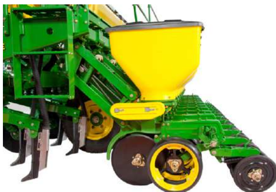
Figura 9. Sistema limitador de profundidade com rodas duplas. Fonte: John Deere (2019).
