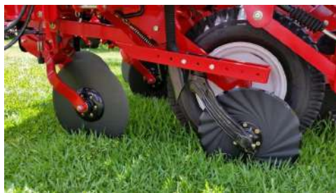
Figura 6. Sistema de abertura de sulco por discos. Fonte: PlantiCenter (2019)
