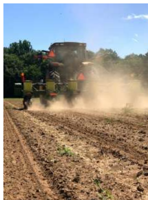
Figura 3. Semeadora com reservatório de sementes nas linhas.
