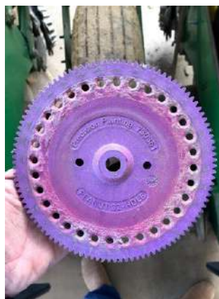
Figura 8. Sistema de dosagem de sementes da PrecisionPlanting. Fonte: Luan Pereira de Oliveira.
