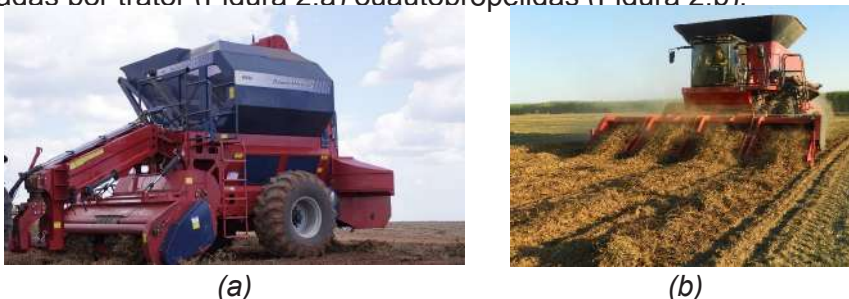
Figura 2. Recolhedora-trilhadora de amendoim: a) tracionada; b) autopropelida.
