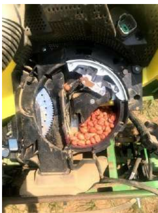
Figura 8. Sistema de dosagem de sementes da PrecisionPlanting. Fonte: Luan Pereira de Oliveira.
