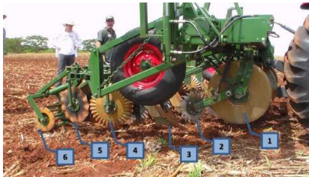
Figura 2. Constituição do rip strip. Fonte: BM Equipamentos Agrícolas (2019).
