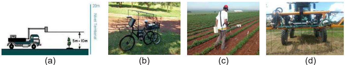
Figura 4. Sensoriamento remoto terrestre* (a) e uso de diferentes plataformas para o sensoriamento remoto terrestre: b) por meio de bicicleta ;c) de forma manual; d) tratorizado.
