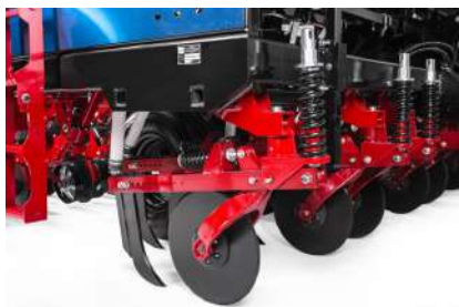
Figura 5. Sistema de abertura de sulco por hastes. Fonte: LS Tractor (2019).
