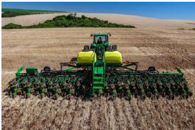
Figura 1. Semeadora com chassi pantográfico. Fonte: John Deere (2019).
